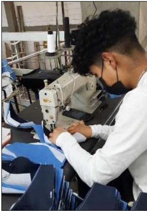
IMAGEN 11. Pegado de pellón y forro
